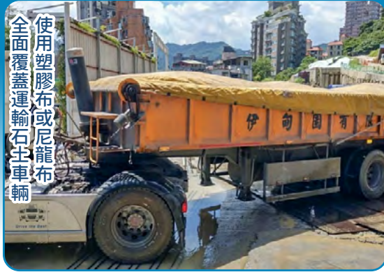
工地車輛全面加裝帆布與防塵罩，以防運輸過程產生揚塵
