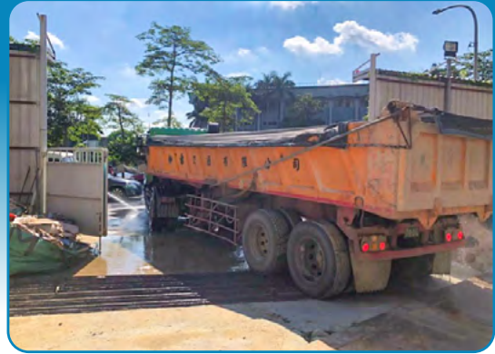
工地車輛全面加裝帆布與防塵罩，以防運輸過程產生揚塵
